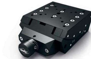
Das Goniometer GO 65-40-65 erlaubt das Schwenken von Aufbauten um eine Achse mit definierter Höhe. Der Schwenkbereich beträgt  $\pm 20^\circ$ . Die Drehachse befindet sich 32,5 mm über der Befestigungsoberfläche und bietet somit genügend Platz für z.B. Prismen, Halterungen, optische Komponenten usw.
